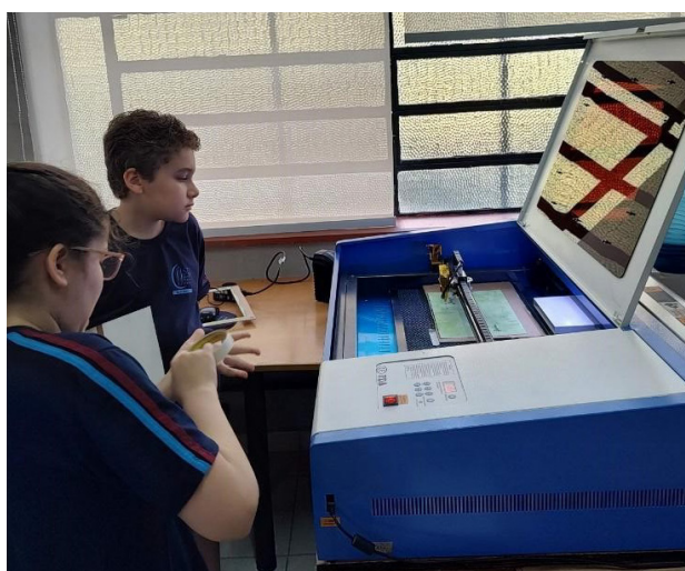
Figura 8: Gravação da capa na CNC de corte laser. (Fonte: O autor, 2024.)
