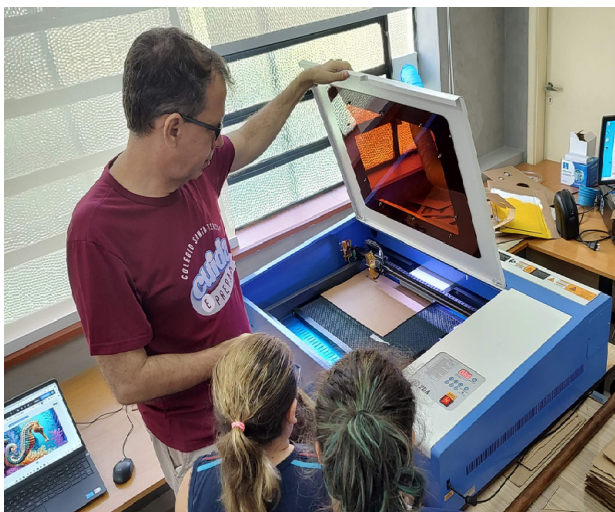
Figura 9: Gravação da capa na CNC de corte laser. (Fonte: O autor, 2024.)
