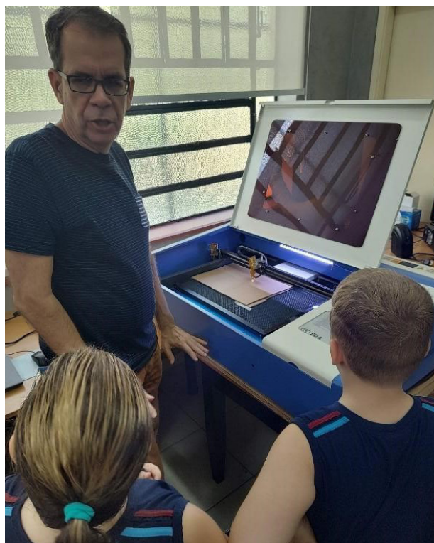
Figura 7: Gravação da capa na CNC de corte laser. (Fonte: O autor, 2024.)
